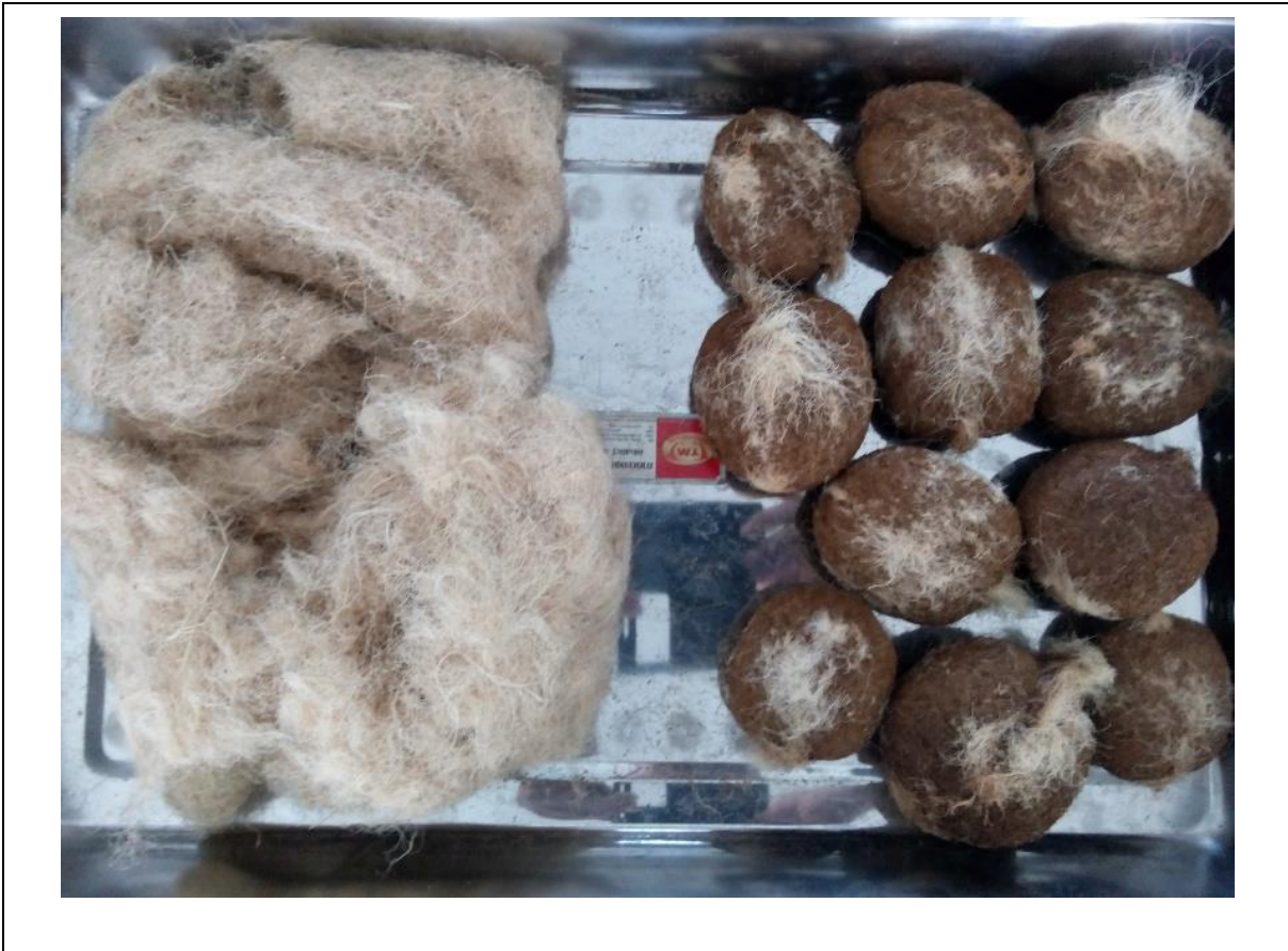
ภาพที่ 12 เส้นใยตาลที่ได้จากเมล็ดตาลแห้งที่ผ่านการดัดหรือแยกเส้นใยโดยเครื่องดัดหรือแยกเส้นใยตาล
